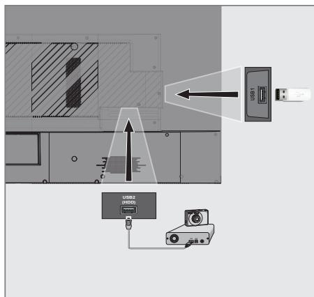
1 Buchse **USB 2 (HDD)** des Fernsehgerätes und entsprechende Buchse des Daten-gerätes (externe Festplatte, Digital-Camera, Kartenlesegerät oder MP3-Player) mit einem USB-Kabel verbinden;
